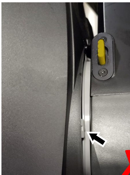
Falsch – Lasche außerhalb der Abdeckung
